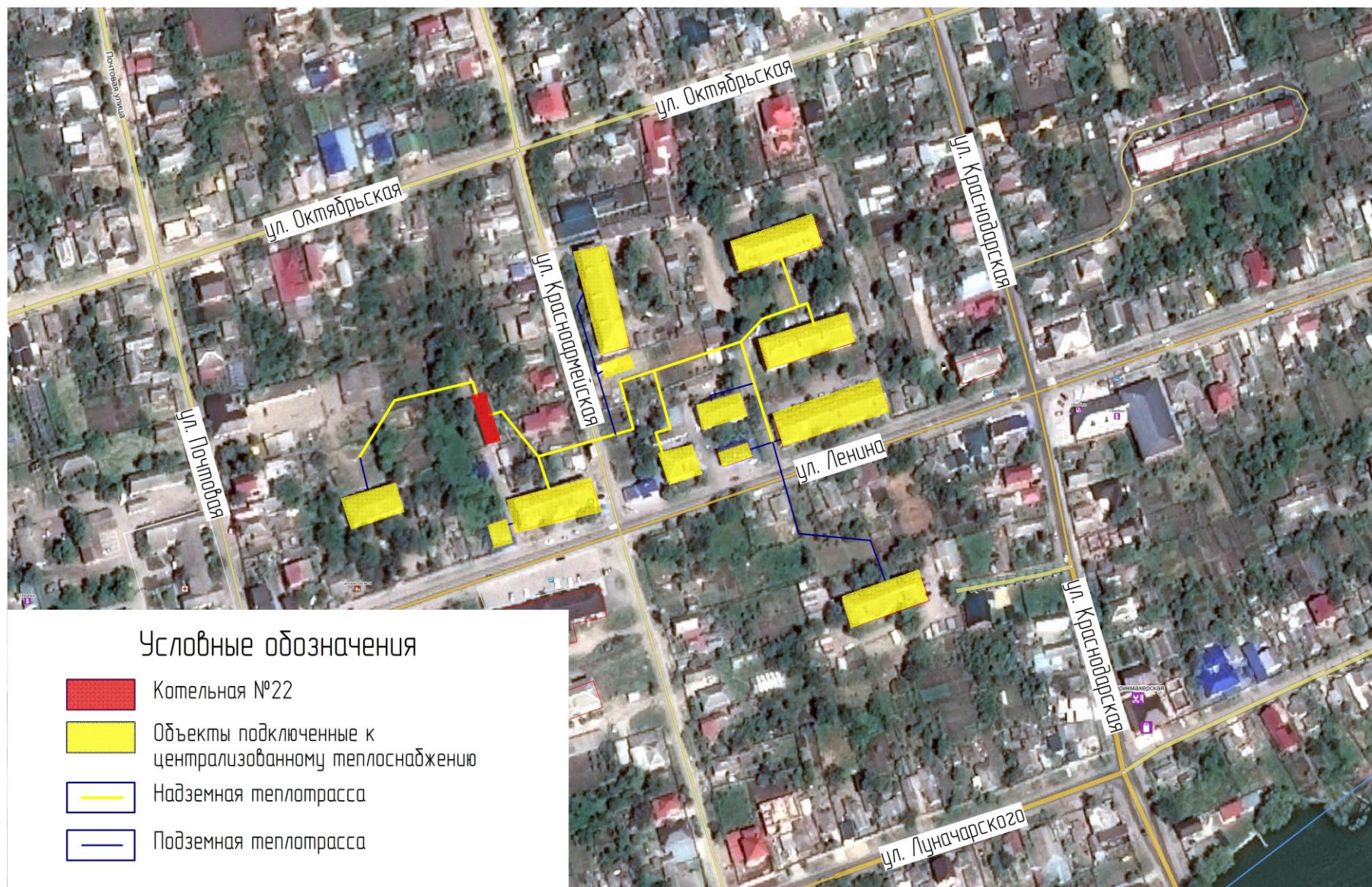
Рис. 2. Схема теплоснабжения Котельной №22
